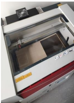
Рисунок 3 – Внешний вид лазерного принтера и изготовленного штампа для изготовления муляжа отпечатка
